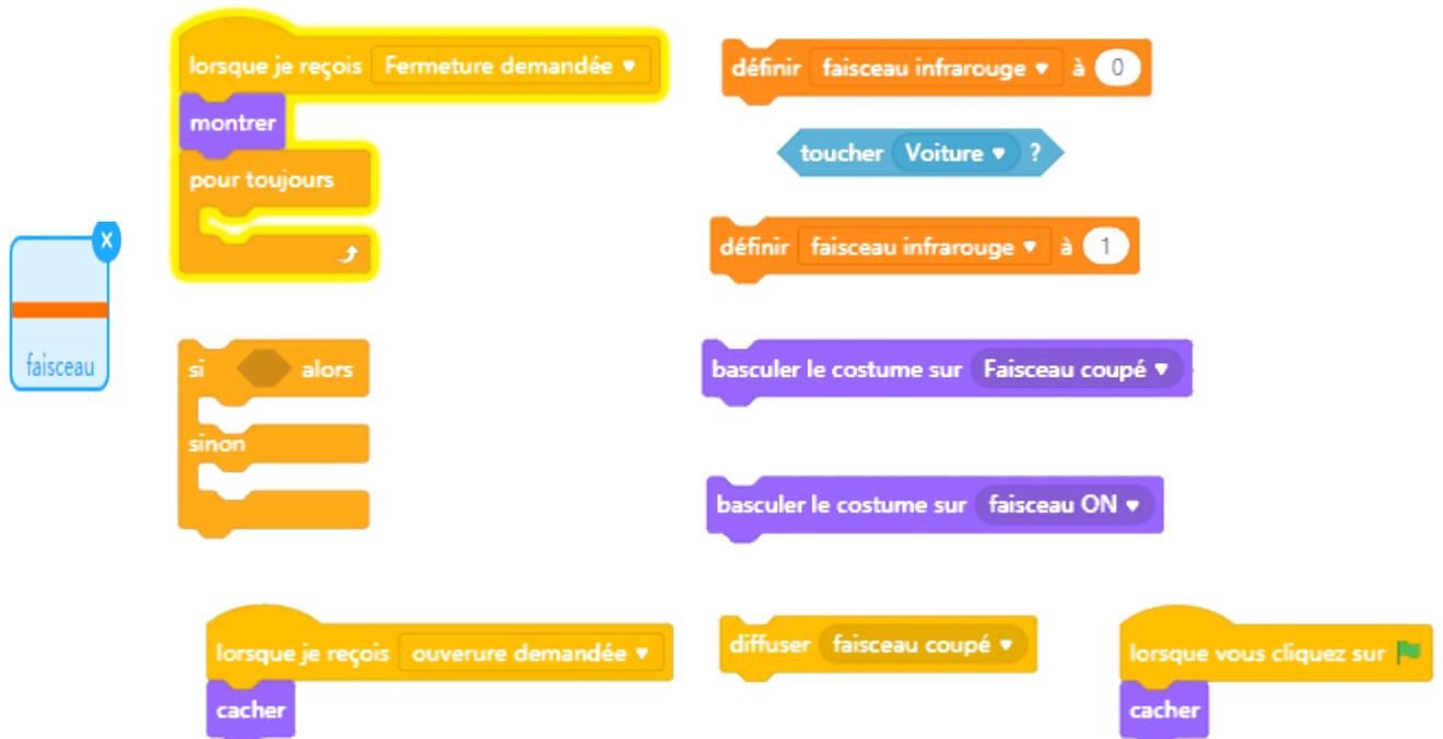
**Interface de programmation :** Lorsque l'interface de programmation reçoit l'information Faisceau coupé, il doit lancer le sous programme ouverture et arrêter les autres programmes.
